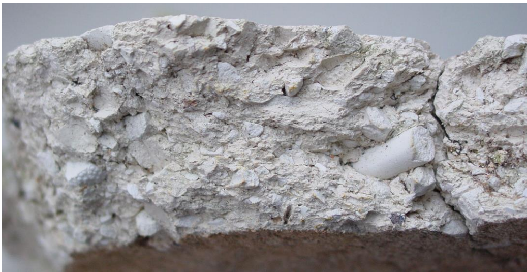
Breukvlak van een vuurvaste tegel met pijpfragmenten.
